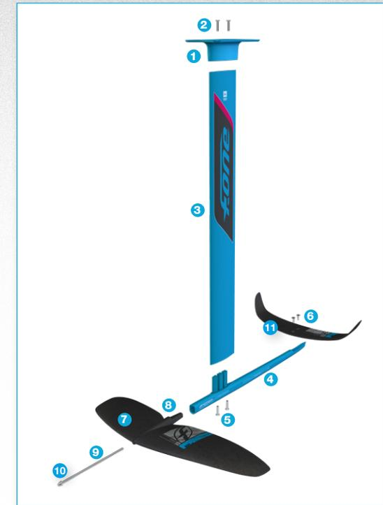
Les ailes avant et arrière fonctionnent comme des plans porteurs, c'est-à-dire qu'elles créent une force de portance au contact de l'eau qui s'écoule autour d'elles avec de la vitesse. C'est la raison pour laquelle les ailes reçoivent un profil spécifiquement étudié.
