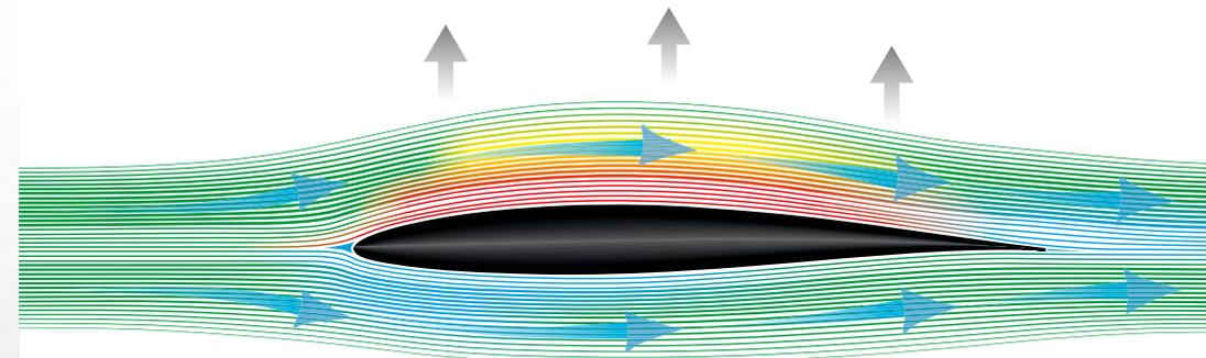
**La forme du profil des ailes ne doit pas être modifiée, enduite ou poncée, au risque de perturber l'équilibre et le fonctionnement du kitefoil.**
