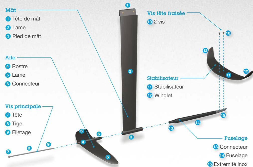
Les ailes avant et arrière fonctionnent comme des plans porteurs, c'est-à-dire qu'elles créent une force de portance au contact de l'eau qui s'écoule autour d'elles avec de la vitesse. C'est la raison pour laquelle les ailes reçoivent un profil spécifiquement étudié.
